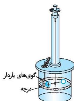
شکل مقابل طرحی از آزمایش کولن (ترازوی پیچشی کولن) را نشان می‌دهد. این وسیله به چه منظور طراحی شده است؟
